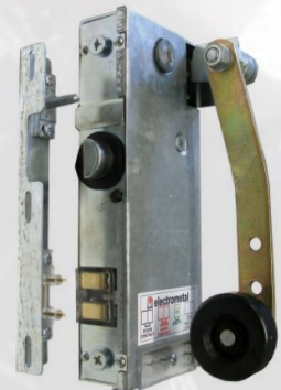
ΚΛΕΙΔΑΡΙΑ Τ.Η. ΜΕ ΕΠΑΦΗ ΘΥΡΩΝ & ΕΠΑΦΗ ΠΑΡΩΝ ΜΕ ΠΡΟΜΑΝΔΑΛΩΣΗ ΚΑΡΦΑΚΙ (ΤΗ) ΒΡΑΧΙΟΝΑΣ ΚΑΘΕΤΟΣ ΕΣΩΤΕΡΙΚΟΣ
